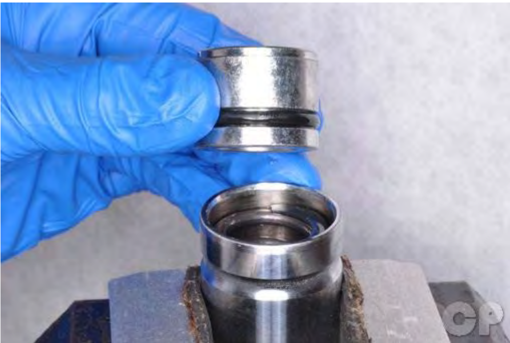
Remove the top plug.
