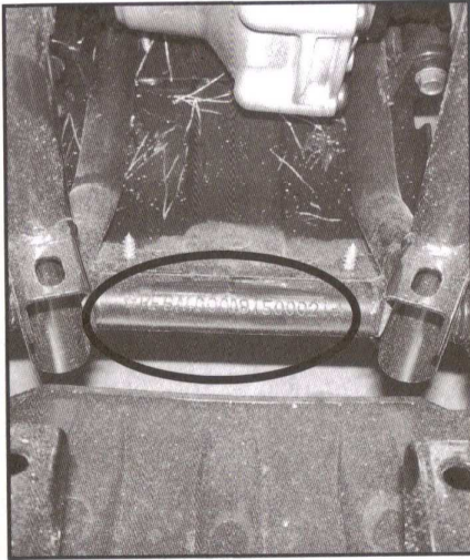
Position der Fahrgestellnummer (Rahmenvorne)
