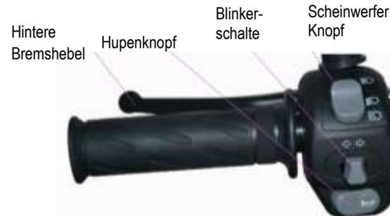
Hinterer Bremshebel: Beim Angreifen des Hebels wird die hintere Bremse betätigt.
