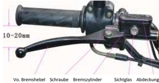
Vo. Bremshebel Schraube Bremszylinder Sichtglas Abdeckung
