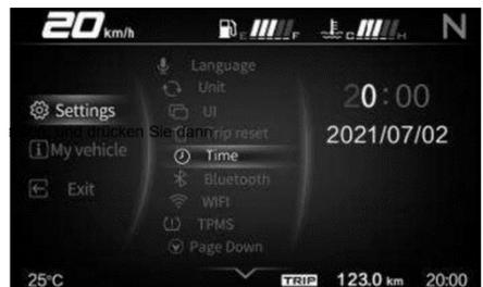
oben“ oder „Nach unten“, um die Zeit anzupassen, und drücken Sie dann kurz „Bestätigen“, um nach oben zurückzukehren. Wenn die Einstellung abgeschlossen ist, halten Sie die Taste gedrückt. Bestätigen Sie, um zum zweiten Menü zurückzukehren. Nachdem sich die mobile App mit der Instrumententafel verbunden hat, bleibt die gleiche Zeitanzeige mit dem Mobiltelefon erhalten.
