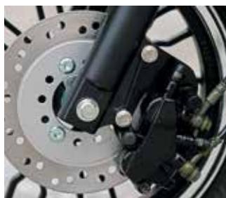
Kombibremse, deshalb die vordere Zange mit drei Kolben
