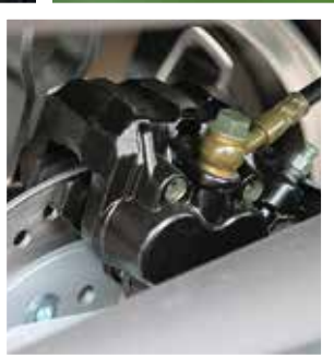
Kombibremse, deshalb die vordere Zange mit drei Kolben
