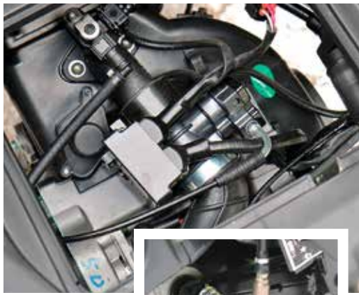
Einspritzelektronik direkt am Motor, Lambdasonde am Krümmer
