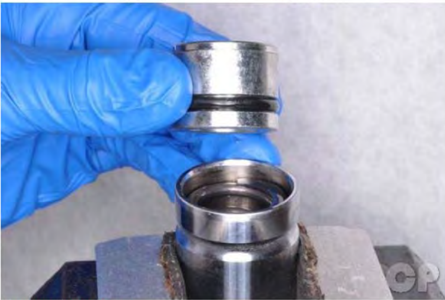
Remove the top plug.
