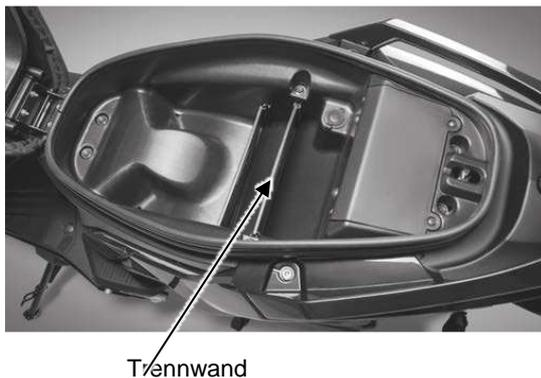
Das Fach ist mit einer herausnehmbaren Trennwand ausgestattet, wodurch das Fach je nach Bedarf in zwei Fächer unterteilt werden kann.
