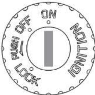
**ON:** Motor und Lichter funktionsfähig.
